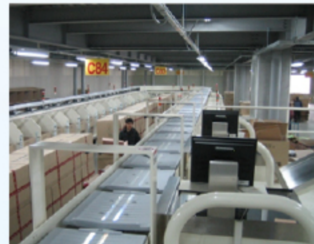
Tilt tray Sorter Tilt tray Sorter는 다양한 레인지의 제품을 분류, 의류, 잡화 Order picking용 Sorter로 적용된다.
