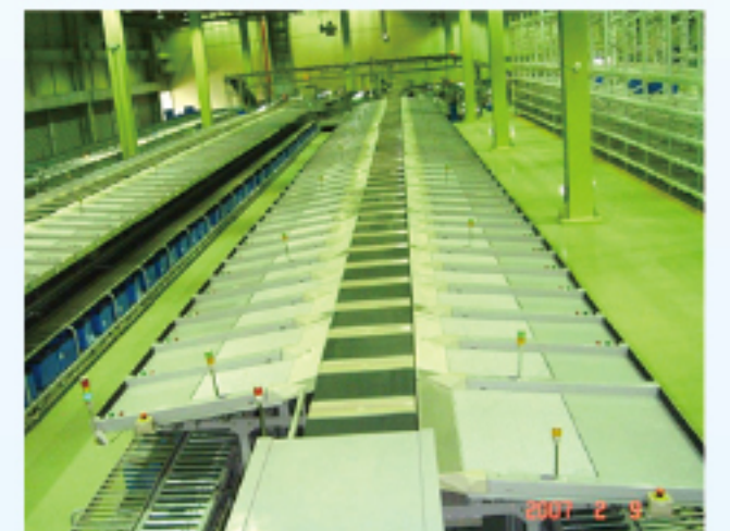
Order 배분용 Cross Belt Sorter-수직 순환형 Cross Belt Sorter는 아주 경량소물 및 중량형등 다양한 레인지의 제품을 분류 할 수 있는 특징으로 Order 배분용 및 방면 별 Sorter의 용도로 적용된다. 특히 Multi Induction이 가능 하며, Chute수가 많을 수록 더 유리한 시스템이다.
