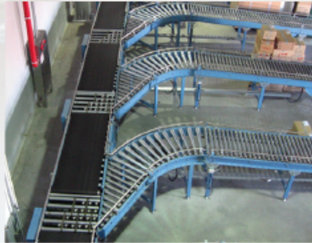
Pop-Up Wheel Sorter-방면별 Sorter 시간당 Max 2400 Box를 처리하는 중 규모 system에 적용된 Pop-Up sorter, 성능 및 내구성이 검증된 안정화된 시스템이다.
