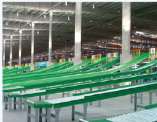
Sortation 시스템에 적용된 Take-away 시스템 무구동 롤러로 구성된 Chute 메인 Sorter에서 배출되는 가지 및 Chute또한 Sortation 구성 요소로 제품의 특성에 따른 적합한 설계가 요구 되어진다.
