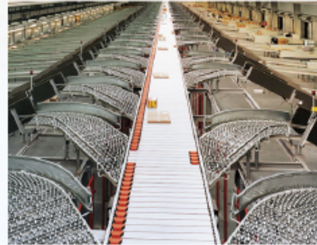
양방향 Sliding Shoe Sorter 제품의 특징에 따라 분류각도를 22도 또는 30도로 설계하여 최적 효율을 낼 수 있도록 한다. Max 시간당 12000개, Max 70Kg /1300MM까지 처리가 가능 하다.
