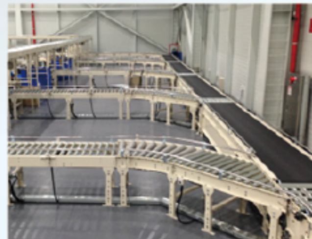
Pop-Up Wheel Sorter-방면별 Sorter Max 60kg제품의 분류를 위해 적용된 Pop-Up Sortation System, Sorter의 특수 설계로 중량물의 분류 에도 적용 되어진 시스템 사례..
