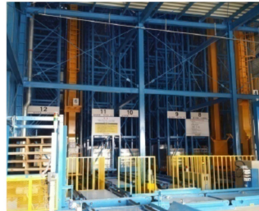
자동차 부품관련 자동화창고 시스템
